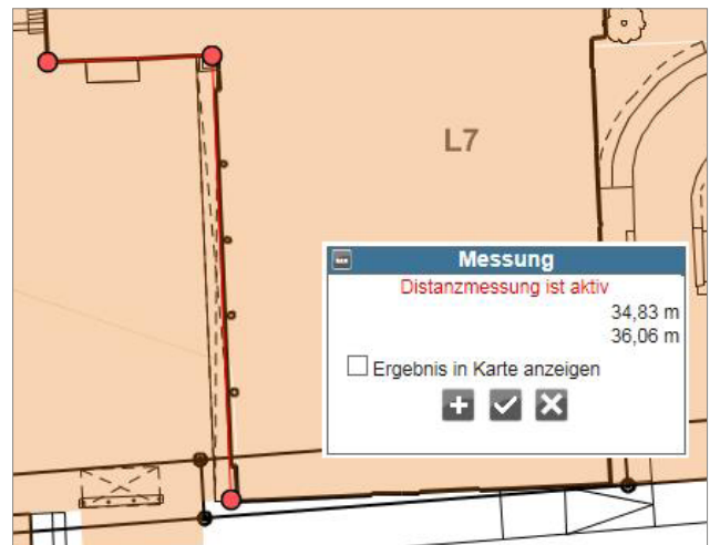
Abb. 17: Die Distanzmessung zeigt die Strecke zwischen mehreren ausgewählten Punkten.
