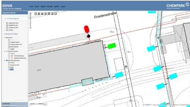
Abb.3: Die GEOPARK Webmap-Karte kann zur Visualisierung der Kabel, Maste und Leuchten mittels Standardtechnik aus LuxData heraus für jede Leuchtstelle aufgerufen werden.
